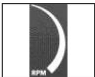
Символ потенциометра оборотов двигателя внутреннего сгорания (только для моделей с двигателем внутреннего сгорания)
