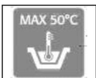
Этикетка, указывающая максимальную температуру воды, которую можно использовать для заполнения бака моющего раствора
