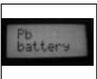
Индикатор вида используемых аккумуляторных батарей (свинцовые)
