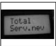
Индикатор вида счетчика часов работы (итого) в верхней строке и вида выполняемых работ (отсутствует) в нижней строке
