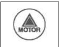
Символ амперметрического контроля двигателя щеток
